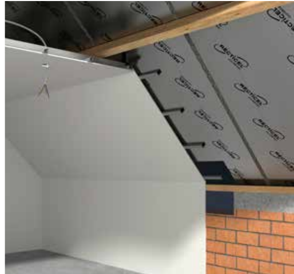
Figuur 21: mogelijke binnenafwerking met kabelspouw
