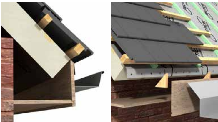
Figuur 18 en 19: houten klossen kunnen zaagafval minimaliseren
