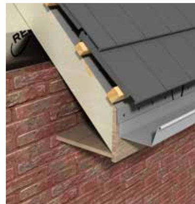
Figuur 20: afschuiving ter hoogte van de goot
