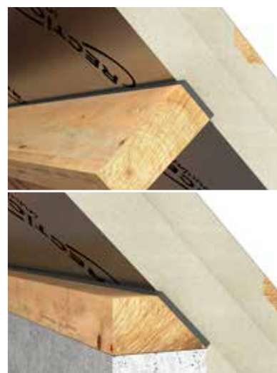
Figuur 1: akoestische onderbreking ter hoogte van de muurplaat, tussengording(en) en nokbalk
