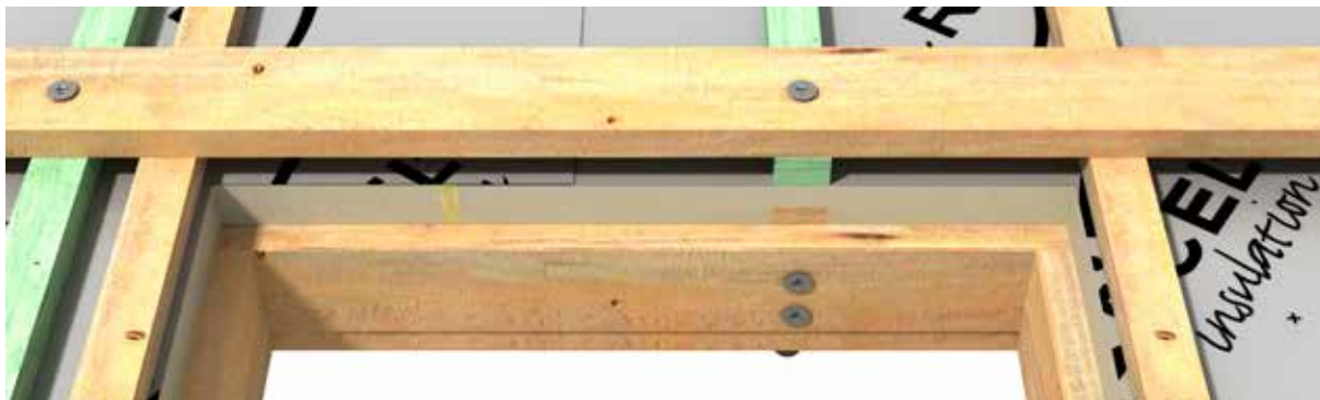
Figuur 12: houten kader vormt geen bouwknoop en wordt bevestigd aan de geïntegreerde balken
